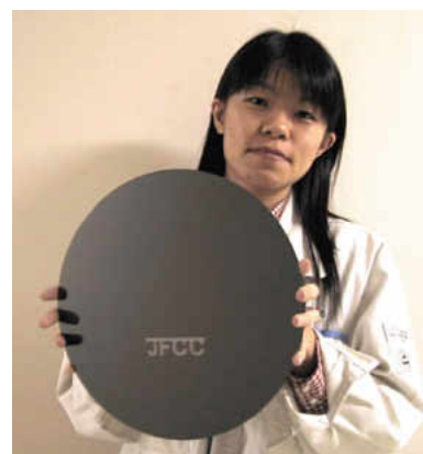
大面積(直径30cm)SiC基板に形成された高密度CNT膜
