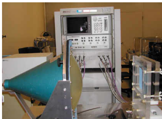
図2 誘電体レンズ付ホーンアンテナを用いた電波吸収量の測定装置
