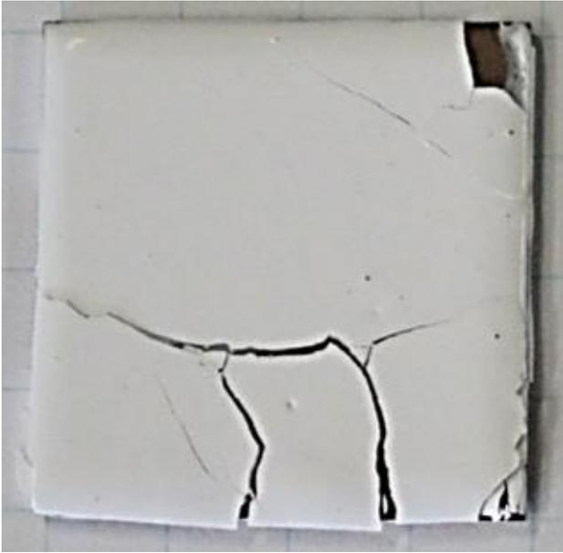
(比較) 従来の電気炉を用いた4時間の脱脂では、割れや反りが生じて、積層造形には適さない。
